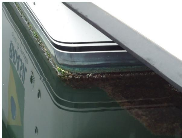
Detalhe do acúmulo de craca na área visível da parte submersa do casco da Seap-08
